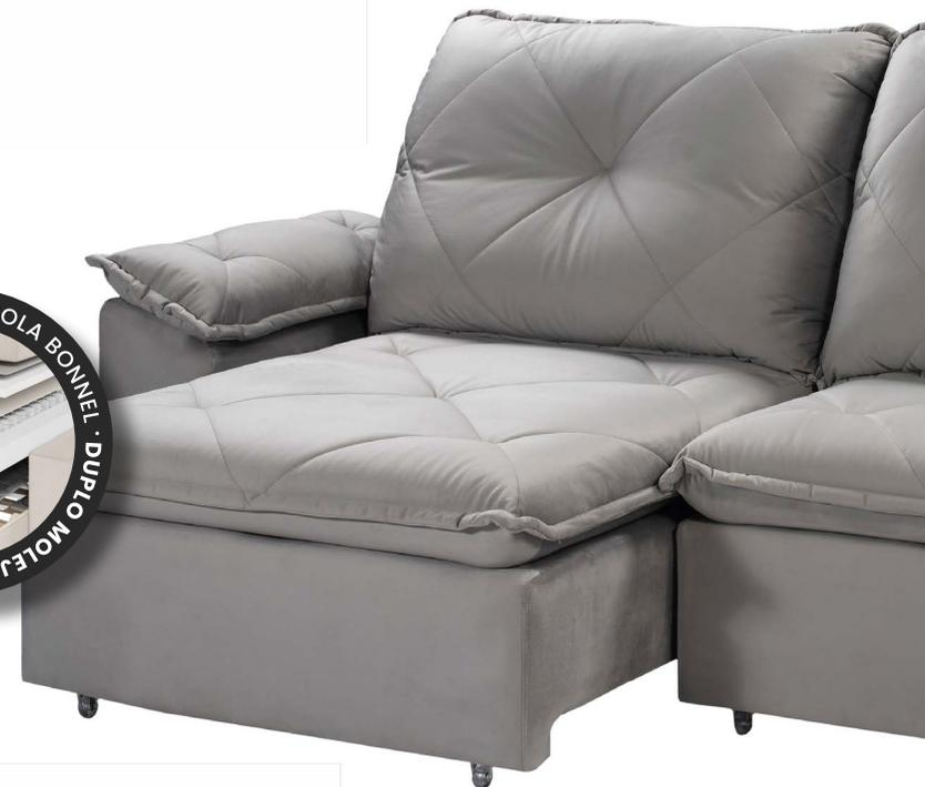
Assento retrátil e sistema de alongamento canaleta. Com espuma de poliuretano flexível D-23, cintas elásticas, além do **Duplo Molejo: molas bonnel + molas ensacadas**. Detalhes de bordado e ponto puxado no encosto e no assento. Encosto reclinável com catraca em 5 estágios, sua almofada é fixa fibra de silicone e espumas, envolvida em manta siliconada. Braços com pillow e detalhe em debrum. Costurado em pesponto. Rodízios de acrílico.
